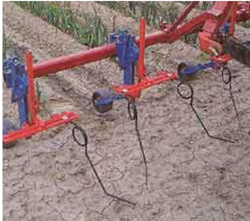
Abbildung 2.3. Torsionshacke. Quelle: Magdalena Lacko-Bartosova.
