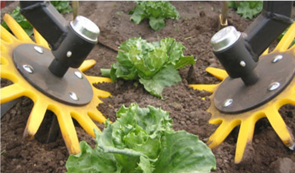
Abbildung 2.2. Fingerhacke (Kress). Quelle: Kress.
