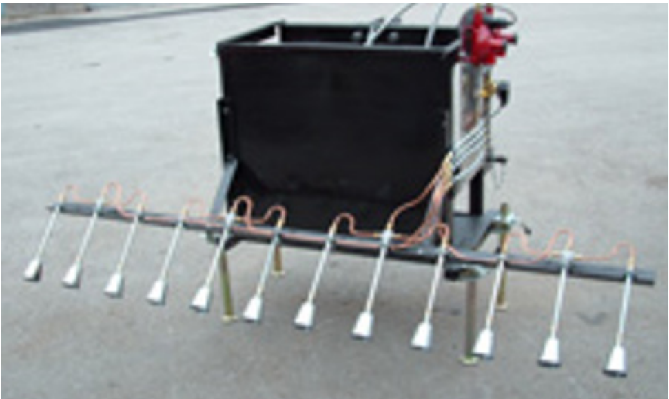
Abbildung 2.6. Unkraut Brenner. Quelle: Magdalena Lacko-Bartosova.
