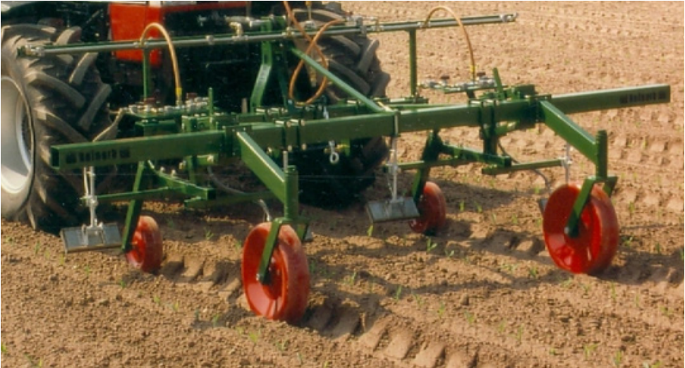
Abbildung 2.5. Unkraut Brenner. Quelle: Magdalena Lacko-Bartosova.
